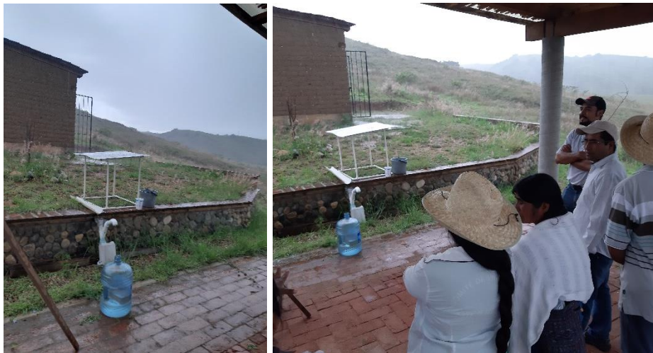
FIGURA 9 Y 10. Presentación de prototipo de sistema de captación de agua de lluvia.
