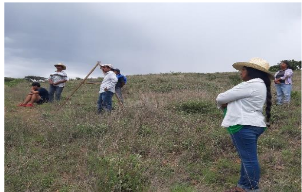
FIGURA 7 Y 8. Práctica de nivelación de terrenos utilizando aparato “A”.
