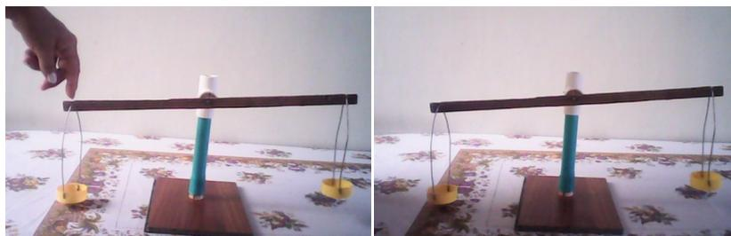
**FIGURA 8(b y c).** Cuando se le da un pequeño empujón a uno de los lados del brazo del instrumento, habiendo estado en equilibrio, se observa que queda inclinada debido al empujón, estando todavía en equilibrio, pues no hay movimiento.
