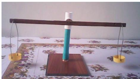
FIGURA 8(a). Cuando el punto de apoyo está en su centro de masa, se observa que el instrumento no hay movimiento.
