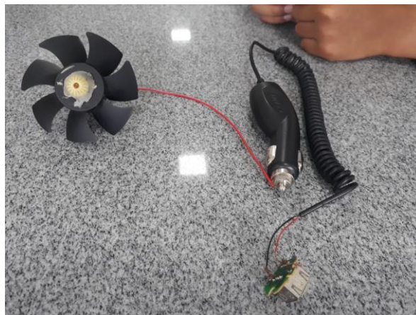
Figura 1. Protótipo do estudante: carregador de celular sustentável feito com a ventoinha de um cooler de CPU ligada por um fio a um cabo adaptador de acendedor de cigarro para veículo. Fonte: As autoras, 2021.
