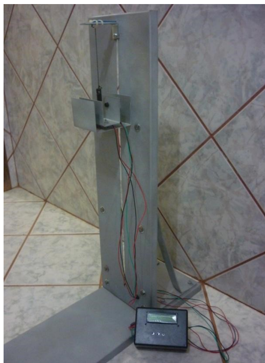
FIGURA 1. Estrutura Física do pêndulo e seu sistema de controle. A estrutura central que contém o sensor é móvel na vertical, o que possibilita a utilização do experimento para vários comprimentos do fio. Na caixa de controle está o microcontrolador ATmega 328 e também o display LCD.
