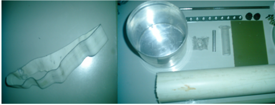
FIGURA 3. Materiais de baixo custo utilizados para construção do Gerador de Van Der Graaf.
