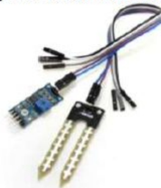
Figura 6: Sensor de humedad el módulo HL-69
