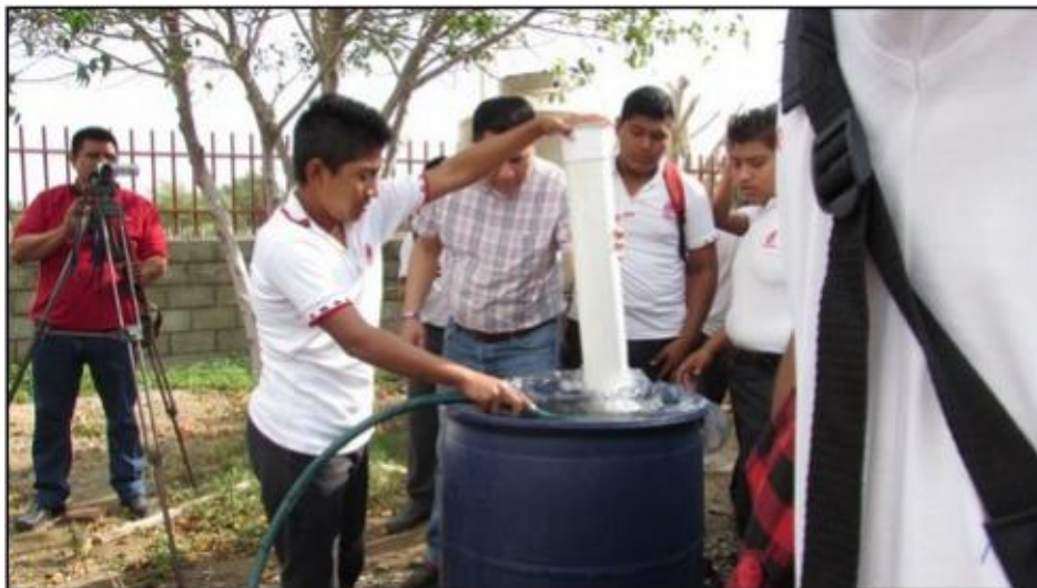
FIGURA 1. Momento en que los estudiantes calculan el tiempo en que tarda en llenarse de gas el tubo de PVC. Foto tomada para los fines de este trabajo el 14 de marzo de 2016.
