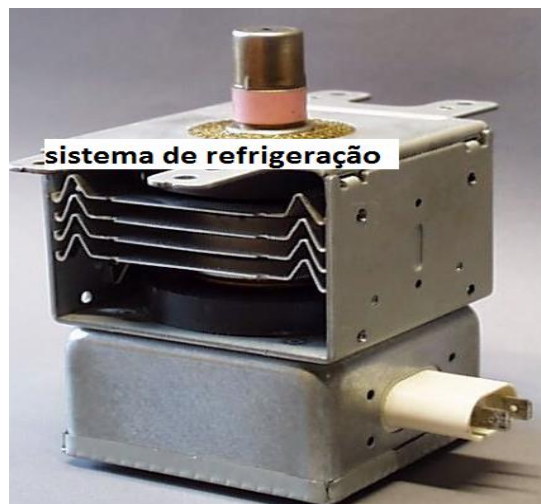
FIGURA 2. Visão externa da válvula magnetron. Foto obtida pelos autores.
