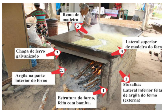
FIGURA 6. A Casa de farinha, lugar que os agentes sociais construíram o forno que serve para escaldar a massa da mandioca, até alcançar o processo de torragem, feito com matéria prima da natureza, com aporte do ferro galvanizado industrializado.
