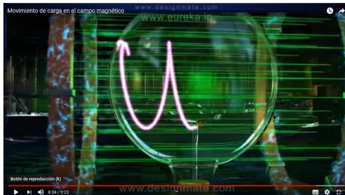
FIGURA 5. Video de movimiento de una carga eléctrica en un campo magnético para analizar el movimiento helicoidal que produce la carga al penetrar el campo cuando se forma un ángulo entre la dirección de la velocidad de la carga y las líneas del campo.
