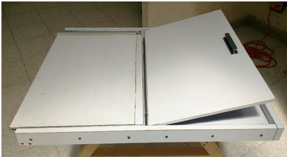
FIGURA 8. Se muestra el prototipo final de la dobladora de acrílico.
