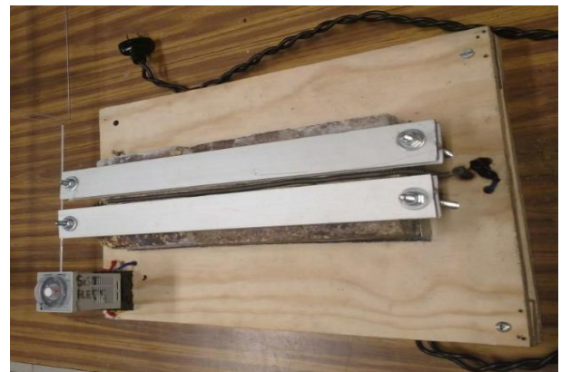
FIGURA 3. Se muestra el primer prototipo de dobladora de acrílico.
