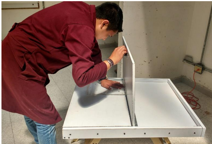
FIGURA 9. Pruebas finales del prototipo final de la dobladora de acrílico.
