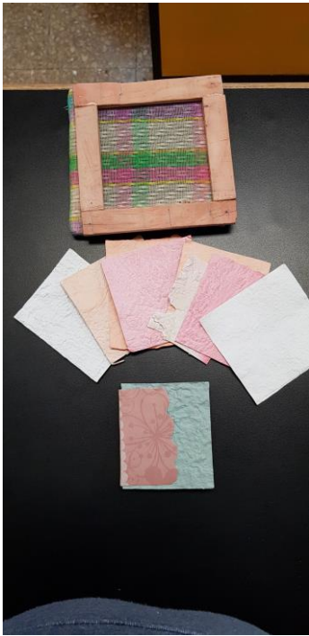
FIGURA 3 y 4. Bastidor y diferentes hojas de papel obtenidas por los alumnos. El color de las hojas varía por la adición de colorantes de tipo vegetal.
