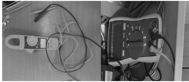
FIGURA 3. Instrumentos de medición eléctrica, a) Multímetro de pinza, b) Multímetro de puntas. Fuente: Autores.
